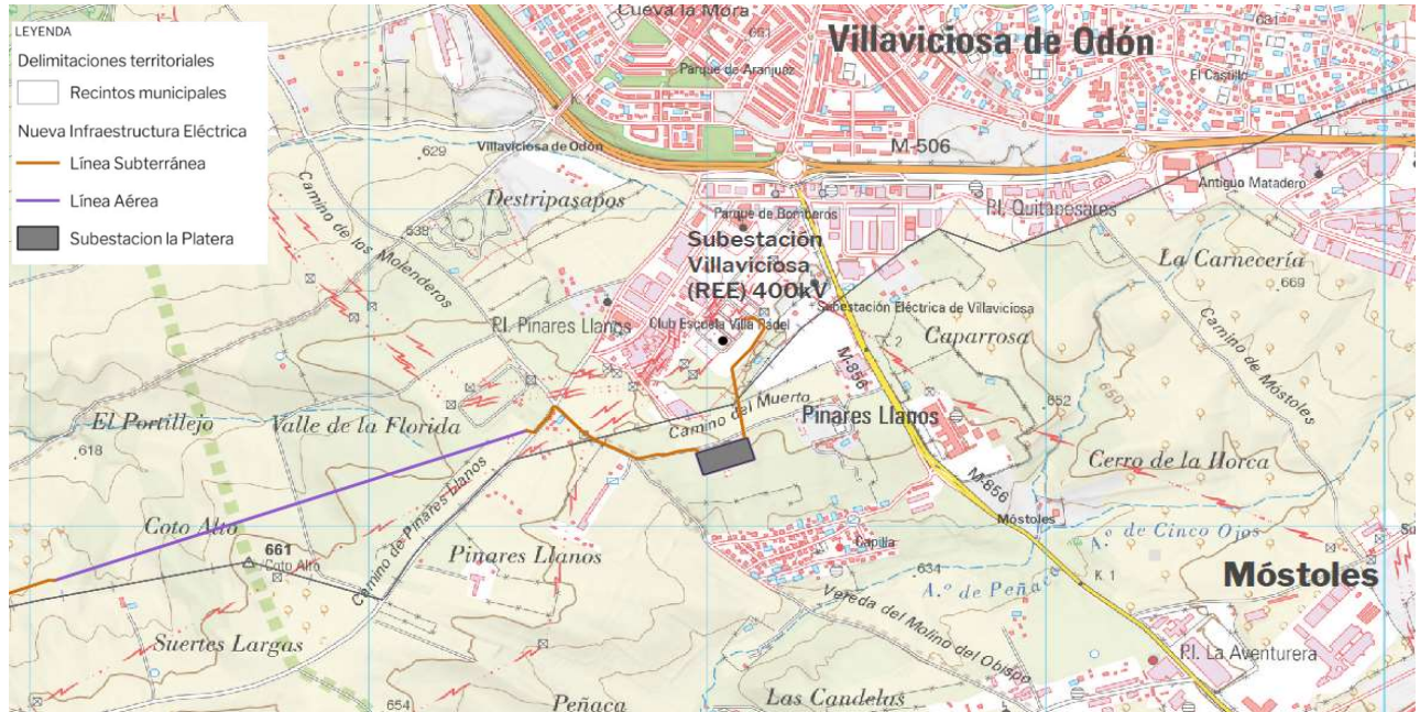
Trazado de la línea de evacuación y localización de las SET La Platera y Villaviciosa (REE) en los TM de Móstoles y Villaviciosa.
